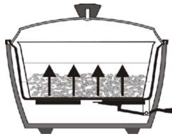
圖 3. 電鍋間接加熱方式及結構
