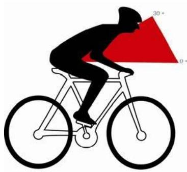
圖 4 以彎型車把手騎乘跑車車架之騎乘姿勢與軀幹角度圖 (本研究繪製)
